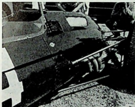
Een Lotus-B.R.M. renwagen met Lucas transistorontsteking. Het koellichaam van het transistor-unit wordt direct gekoeld door de rijwind.
